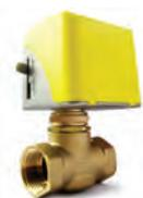
Универсальные смесительные 2-х и 3-х ходовые клапаны серии GMV с сервоприводом. Клапаны GMV типа «открыт/закрыт» предназначены для регулирования подачи теплоносителя и подходят для работы со всеми типами фанкойлов. Электроприводы клапанов оснащаются 2-х жильным подключением электропитания и могут использоваться с большинством пультов управления и электронных термостатов.
